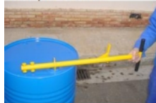
Palanca para la apertura del Tapón Grande
