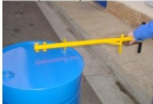
Palanca para la apertura del Tapón Pequeño
