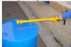
Palanca para la apertura del Tapón Pequeño
